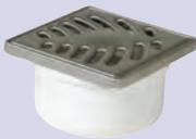
■ Ø 40/50 mm ■ Hauteur : 57 mm ■ Garde d'eau 28 mm ■ Bon débit ■ Nettoyage facilité avec un accès complet à la canalisation ■ Pas de reprise d'étanchéité ■ Grille : 100 x 100 mm, inox et cadre inox
