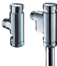
■ Installation murale en applique ■ Déclenchement souple, temporisation ~7 s ■ Protection antisiphonique ■ Corps et bouton en laiton massif chromé ■ Alimentation équerre M3/4", avec écrou de sortie Ø 28 ■ Débit de base : 1 L/sec ■ Garantie 10 ans
