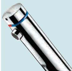
■ Réglage de la température et déclenchement sur le croisillon ■ Temporisation ~7 s, débit pré-réglé à 3 L/min à 3 bar, ajustable de 1,5 à 6 L/min ■ Brise-jet anti-tartre inviolable ■ Fixation renforcée par 2 tiges inox ■ Flexibles PEX F3/8" avec robinets d'arrêt, filtres et clapets anti-retour ■ Butée de température réglable ■ Garantie 10 ans
