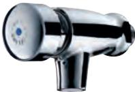
■ Temporisation ~7 s ■ Débit pré-réglé à 3 L/min à 3 bar, ajustable de 1,5 à 6 L/min ■ Brise-jet antitartre inviolable ■ M1/2" ■ Garantie 10 ans
