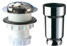
■ Crépine Inox ■ Corps en polypropylène, sortie Ø 40 mm avec écrou ■ Siphon d'urinoir vertical Ø 50 avec joint à lèvres ■ Sortie Ø 32 avec écrou, garde d'eau 50 mm ■ Garantie 10 ans
