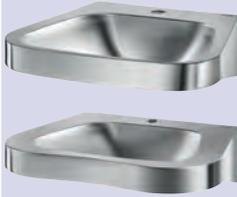
■ Finition poli satiné, épaisseur inox : 1,2 mm ■ 530 x 470 mm ■ Finition anti-coupures ■ Avec trou de robinetterie Ø 35 au centre ■ Bonde 1"1/4, sans trop-plein, avec fixation ■ Marquage CE, conforme à la norme EN 14688 ■ Poids : 4.65 kg
