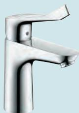
■ Hauteur 20 cm ■ Hauteur sous bec 9,4 cm ■ Longueur de bec 11,9 cm ■ Démarrage en eau froide en position de poignée centrée ■ Cartouche céramique ■ Limiteur de température réglable ■ E00 Ch3 A3 U3
