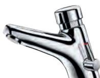
■ Temporisation ~7 s, débit pré-réglé à 3 L/min à 3 bar, ajustable de 1,5 à 6 L/min ■ Brise-jet antitartre inviolable ■ Fixation renforcée par 2 tiges inox ■ Flexibles PEX F3/8" avec robinets d'arrêt, filtres et clapets anti-retour ■ Réglage de température latéral avec manette standard et butée de température réglable ■ Système antiblocage AB : écoulement uniquement lorsque le bouton poussoir est relâché ■ Garantie 10 ans
