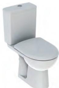
■ Rinçage double touche ■ Cuvette Rimfree sans bride ■ Réservoir réversible, pour alimentation latérale ■ Type 1, volume total 6 L, selon EN 997 ■ Alimentation latérale ■ Sortie Horizontale ■ Abattant WC en duroplast ■ Couvercle d'abattant recouvrant
