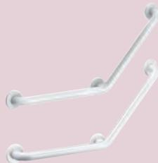
■ Ø 32 mm, nylon HR brillant blanc ■ Utilisation comme barre d'appui (partie horizontale) ou de relèvement (partie à 135°) ■ 3 points de fixation ■ Surface uniforme ■ Écartement au mur de 38 ou 40 mm ■ Fixations invisibles par platine ■ Testée à 200 kg ■ Disponible en version inox satiné ou poli brillant, 2 ou 3 points ■ CE - Garantie 10 ans
