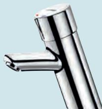
■ Réglage de la température et déclenchement sur le croisillon ■ Temporisation ~7 s, débit pré-réglé à 3 L/min à 3 bar, ajustable de 1,5 à 6 L/min ■ Brise-jet anti-tartre ■ Fixation renforcée par 2 tiges inox ■ Flexibles PEX F3/8" avec robinets d'arrêt, filtres et clapets anti-retour ■ Butée de température réglable, croisillon ergonomique en métal chromé ■ Garantie 10 ans
