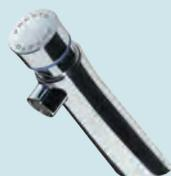
■ Robinet simple sur plage ■ Débit 3 L/min à 3 bars ■ Réglage 4 positions ■ Temporisation 15 s ± 5 s ■ Résiste à une température de 75°C durant 30 min dans le cadre de chocs thermiques ■ Mâle G 1/2" (15x21) en eau froide
