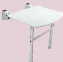
■ Relevable avec pieds rentrants articulés ■ Pieds ajustables rapidement en hauteur (de 400 à 500 mm) sans aucun outil ■ Assise large, polypropylène chaud au toucher ■ Polypropylène antibactérien traité dans la masse de la plaque d'assise ■ Perçages en milieu de siège pour une bonne évacuation de l'eau ■ Pieds avec patins antidérapants ■ Visserie en inox 304 et fixation renforcée par 2 points de fixation ■ Testé à 175 kg suivant EN1218
