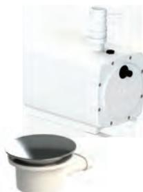
■ Adaptées à l'installation d'une douche à l'italienne ■ Débit d'évacuation important 30 L/min à 1 m ■ Ø d'entrée 16 mm ■ Ø de refoulement 32 mm ■ Alimentation 220-240 V / 50 Hz ■ Intensité max. absorbée 1,7 A ■ Consommation moteur 400 W ■ Classe électrique 1 ■ Température maximum des eaux usées entrantes 35 °C ■ Bonde pour receveurs extra-plat : 57 mm
