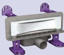
■ Débit d'absorption de 0,6 L/s ■ Équipé d'un système anti-odeurs amovible avec une garde d'eau de 22 mm ou un clapet anti-odeurs Multistop ■ Sortie horizontale Ø 50 mm sur 3 faces ■ Équipé d'une plaque de façade en inox avec 3 designs au choix ■ Sans éclairage LED (RVB) ■ Choix de la couleur par l'utilisateur
