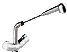
■ Mitigeur monotrou d'évier ■ Double sécurité ECS et brûlure ■ Douchette extractible, flexible lisse ■ Hauteur sous bec 231 mm ■ Corps à intérieur lisse ■ Brevet MASTERMIX : intercommunication ECS et EFS impossible ■ Double butée de température à 38 et 41° déverrouillable pour choc thermique par service technique
