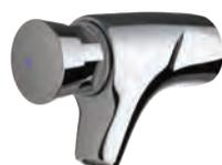
■ Temporisation 15 s ■ Débit 3 L/min réglable ■ Bouton antirotation évitant tout risque d'usure prématurée ■ Alimentation hydraulique : mâle G 1/2" (15 x 21) en eau froide ■ Repère par point de couleur inusable et indémontable ■ Corps en laiton chromé
